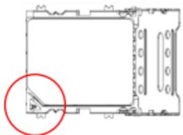
④カバーを閉じて矢印の方向にスライドさせてロックをかけます。
